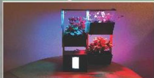
Die entwickelte Anlage besteht aus standardisierten Aluminiumprofilen, die als Säulen fungieren. Der Vorteil der Aluminium Profile und der 3D gedruckten Komponenten sind, dass sie in der Grösse einfach skalierbar sind.
